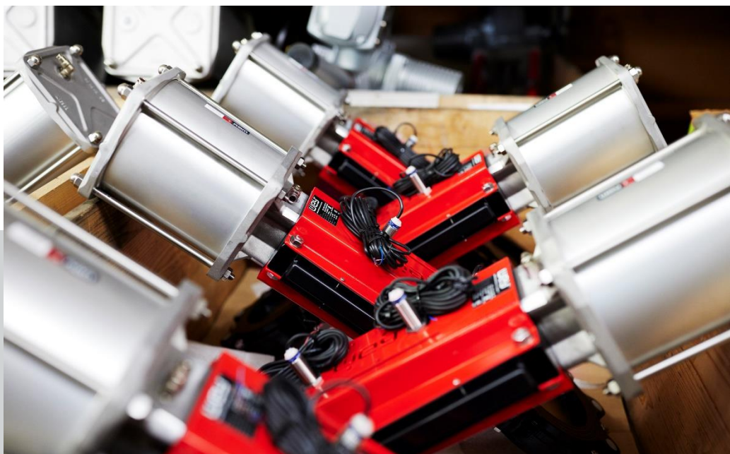
Vannes guillottes pneumatiques VNC avant la livraison
