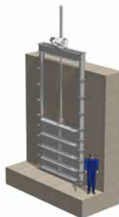
Vanne normalisée Wey type 2 avec des tailles de plusieurs m 2
